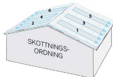
Skottningsordning för att undvika ojämna takbelastning.
